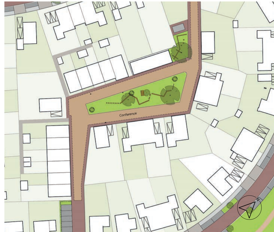
principe inrichting erf met 1m zone en rijloper in onderscheidende bestratingsmixen
