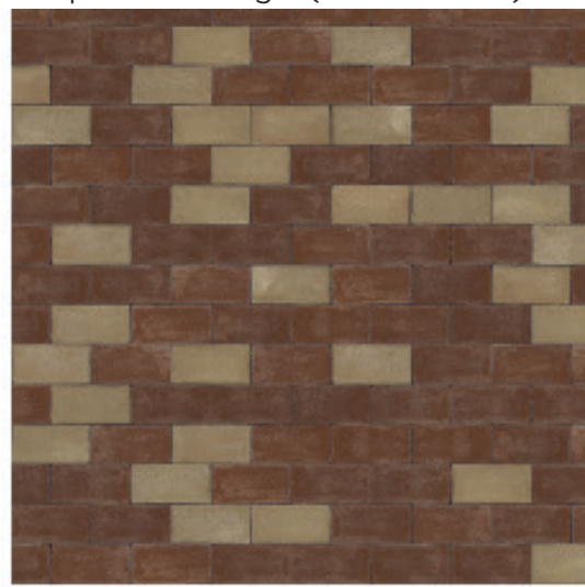
bestratingsmix erven: randen SBS keiformaat halfsteensverband verhouding rood/geel = 70/30
